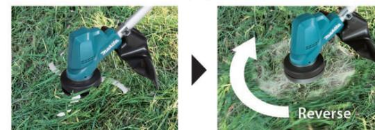
Equipada con un interruptor de reversa para facilitar la eliminación de los recortes de hierba atascados en la cuchilla; los recortes de hierba pueden eliminarse de la cuchilla y alrededor de ella mediante la rotación inversa lenta de la cuchilla.
